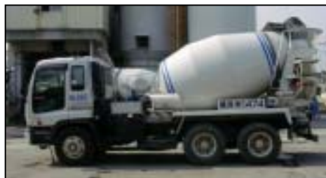
写真 流動化処理土運搬車
